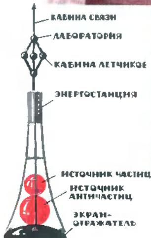
Важным фактором любого реактивного двигателя является скорость истечения рабочего тела и удельная тяга. В химических двигателях эта скорость достигает 2500—3500 м/сек. В фотонном двигателе она равна 300 000 000 м/сек. С таким двигателем можно побывать и на других звездах.
